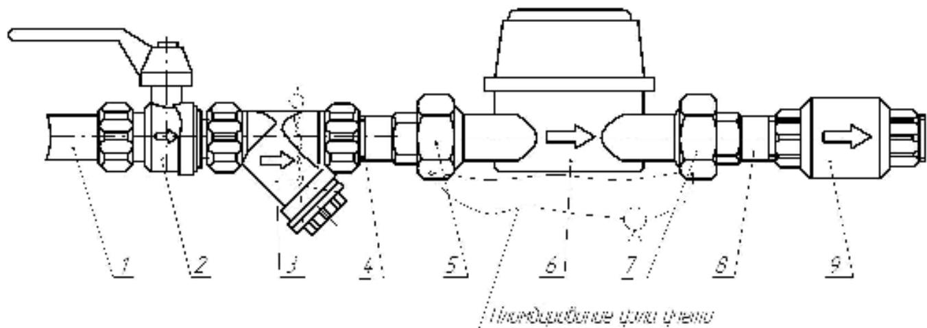
2-кран шаровой; 3- фильтр; 4- ниппель; 5-гайка накидная; 6-счетчик воды; 7-гайка накидная;
