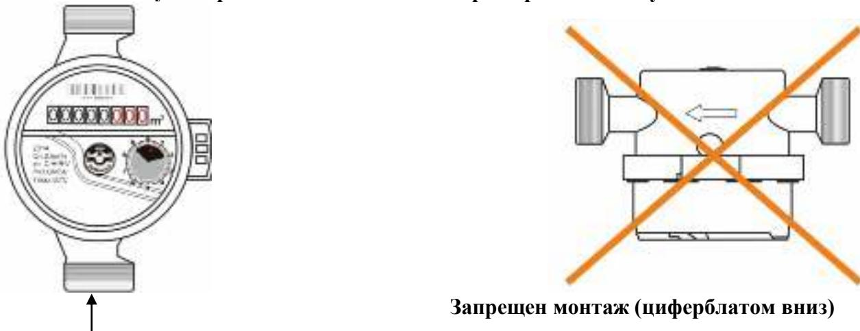
**Запрещен монтаж (циферблатором вниз)**
