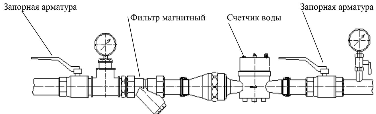
**Пример пломбирования узла учета**
